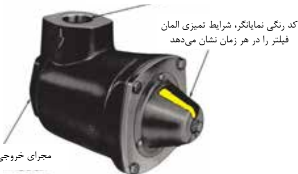
شکل ۱۴-۴- نمایانگر وضعیت فیلتر، موقعی که احتیاج به تمیز کردن فیلتر باشد به اپراتور علامت می دهد
