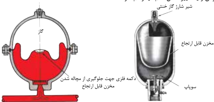
شکل ۴-۱۰- آکومولاتور گازی نوع دیافراگمی
