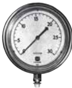
شکل ۱۰-۱- یک نمونه خلاسنج بر حسب اینچ جیوه
