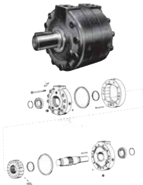
شکل ۲۰-۵- موتور پره ای تولید کننده گشتاور زیاد
